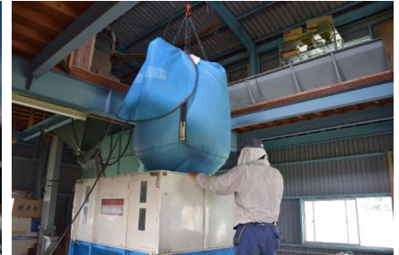
籾 乾燥機への格納作業
